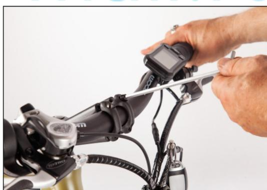
Еще раз проверьте параллельность оси выноса руля по переднему колесу велогибрида и затяните при помощи шестигранников болты крепления выноса.
