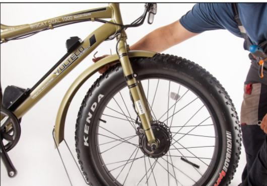
Выкрутите при помощи шестигранника и гаечного ключа крепёжный болт на передней вилке и закрепите с его помощью переднее крыло и багажник в последовательности, показанной на фото.
