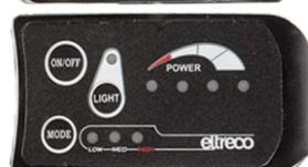
**Пульт управления** с LED-индикацией позволяет включать/выключать питание электромотора, головной свет (при его наличии), выставлять один из трех уровней режима помощника при педалировании (LOW / MED / HIGH), а также отображает примерный уровень заряда аккумуляторной батареи.
